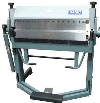
**Die Segmentbiegemaschine dient zum Biegen von Metall, zum Formen von Wasserablaufkästen und Verkleidungskassetten**
